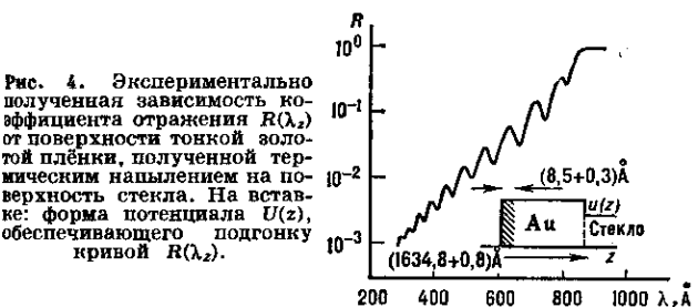
Рис. 4. Экспериментально полученная зависимость коэф. отражения R(\lambda z) от поверхности тонкой золотой плёнки, полученной термическим напылением на поверхность стекла. На вставке: форма потенциала U(z) , обеспечивающего подгонку кривой R(\lambda z) .
